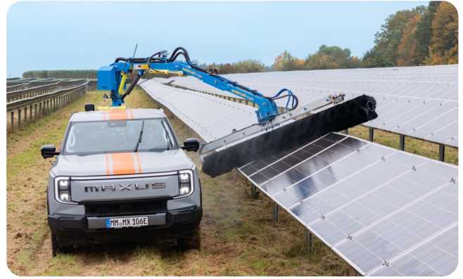
Eagle full electric · flexibilidad y huella mínima. Montado sobre un pick-up eléctrico, llega a accesos complejos con maniobrabilidad fina y operación limpia.
