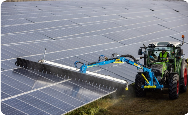
TrackFlex · grandes superficies. Brazo de largo alcance sobre tractor para barrer filas largas con alto rendimiento por hora. Ideal para parques en suelo de gran escala.
